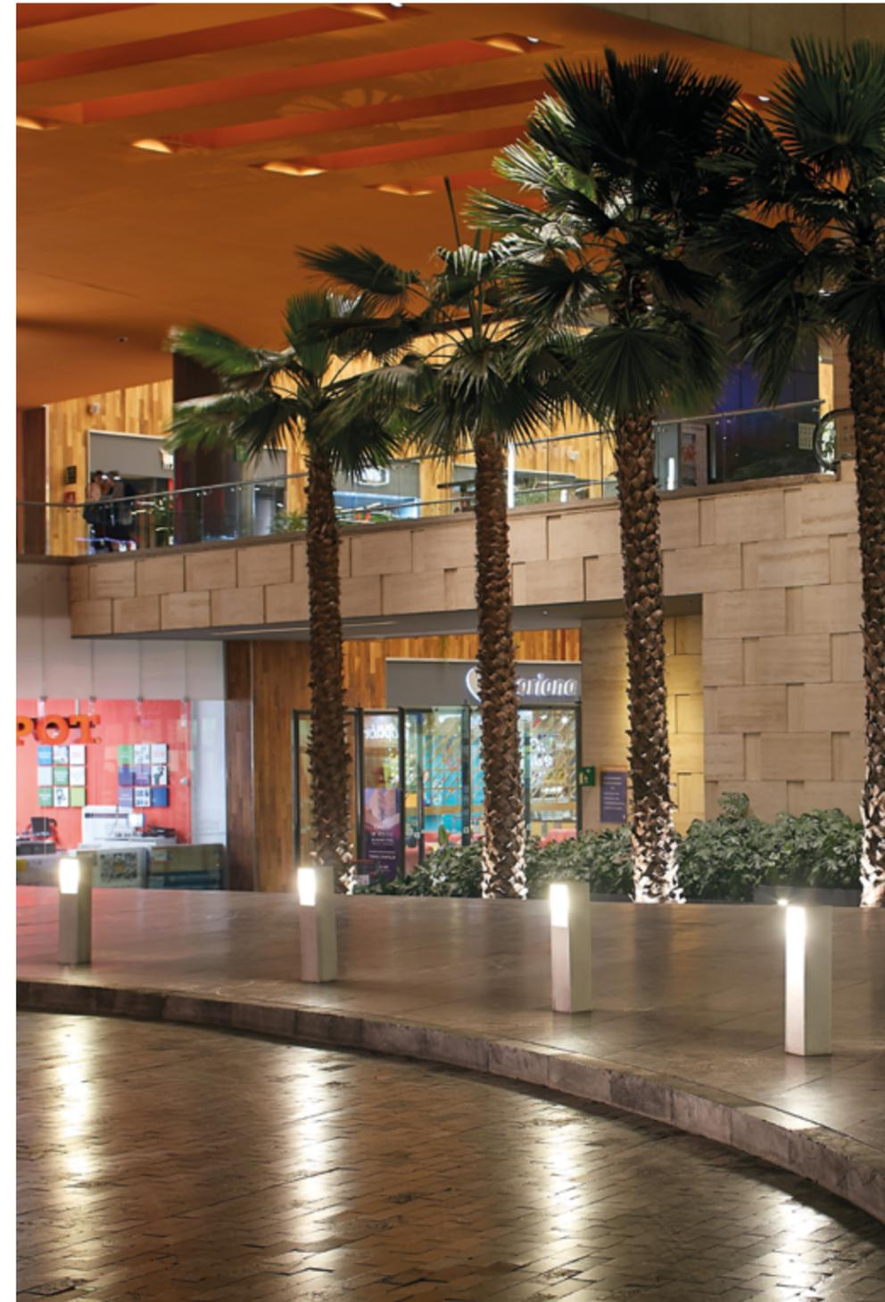
Las áreas de acceso a inmuebles deben de estar bien iluminadas sin causar ningún deslumbramiento. La luz de cortesía es un recurso que sirve para guiar a los transeúntes sin tener que elevar los niveles de iluminación.
