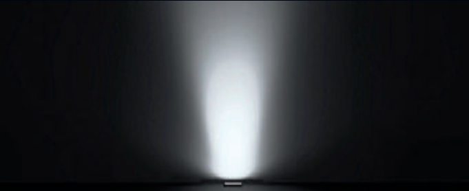
Óptica de 24° ajustada 5° sobre el eje horizontal. A una separación de 0.30 m del muro
